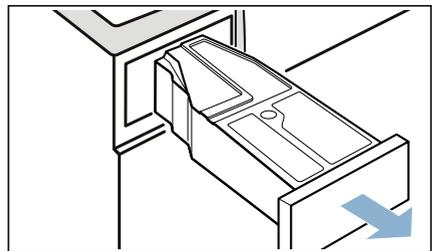
8. Girar el depósito de agua condensada 180° hasta dejarlo boca abajo y retirar el tapón que lleva.
