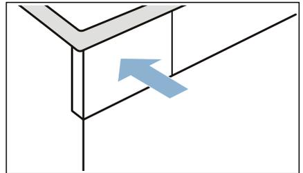
**Nota:** El filtro ubicado en el recipiente de agua condensada filtra el agua condensada que se utiliza para la limpieza automática del electrodoméstico. El filtro se limpia al vaciar el agua condensada. No obstante, es necesario comprobar periódicamente el filtro y, en caso de ser necesario, eliminar los posibles residuos que se hayan podido acumular.
