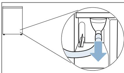
**Nota:** En el momento de entrega del aparato, el tubo del agua condensada está fijado en el tubo de empalme.
