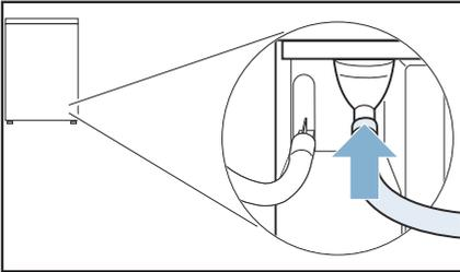
6. Según la situación de conexión, fijar la otra parte del tubo de desagüe con el resto del accesorio.
