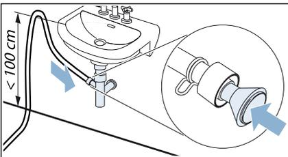
El punto de empalme tiene que estar asegurado con una abrazadera (rango de sujeción 12-22 mm en comercios especializados).
