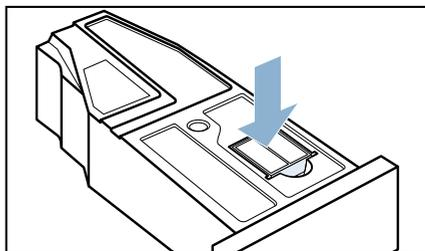
12. Colocar el recipiente para agua condensada y empujarlo hasta que quede bien encajado.
