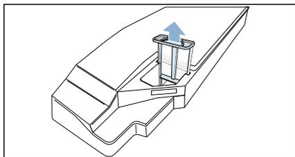
11. Colocar el filtro en la ranura del recipiente para agua condensada.
