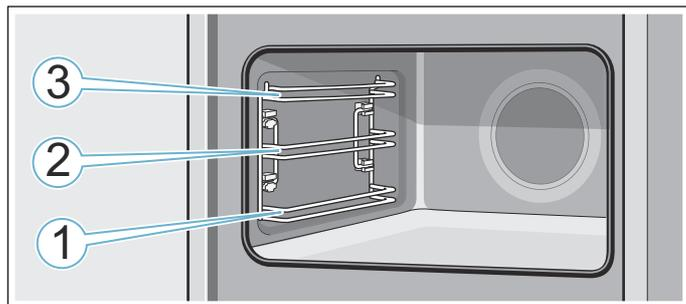
Aux niveaux d'enfournement 1, 2 et 3, introduire l'accessoire toujours entre les deux barres de guidage d'un niveau d'enfournement.
