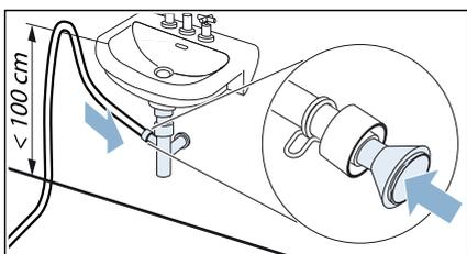
Le point de raccordement doit être fixé par un collier de serrage (plaque de serrage 12-22 mm, commerce spécialisé).
