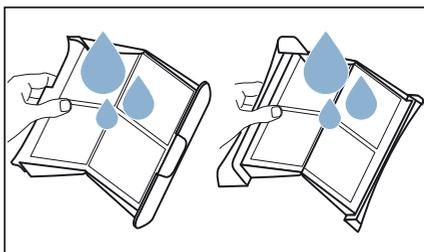
8. Séchez les filtres à peluches, remettez-les en place l'un dans l'autre.
