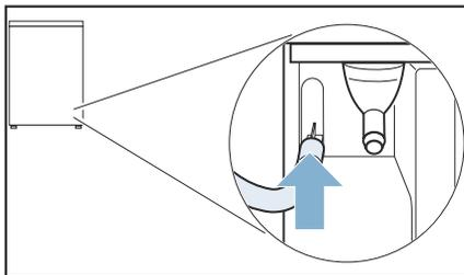
5. Retirez le tuyau d'évacuation, fixez-le sur les supports détachés et poussez-le jusqu'en butée.
