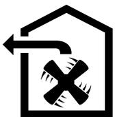
Die angesaugte Luft wird durch die Fettfilter gereinigt und durch ein Rohrsystem ins Freie geleitet.
