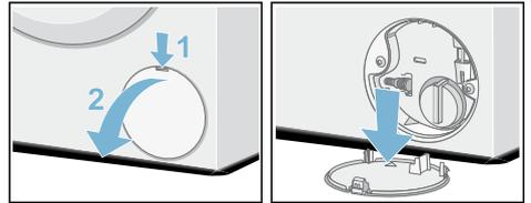
4. Extraer la manguera de desagüe del soporte. Retirar el tapón de cierre y recoger el agua de lavado en un recipiente adecuado. Volver a colocar el tapón de cierre y la manguera de desagüe en el soporte.
