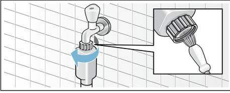
6. Para modelos estándar y con sistema AquaSecure, limpiar el filtro en la parte trasera del electrodoméstico:
