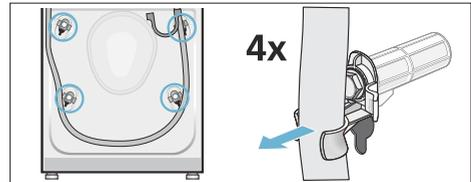
2. Retirar el cable de alimentación de los soportes. Desatornillar y retirar los cuatro tornillos de los seguros de transporte. Retirar los manguitos.
