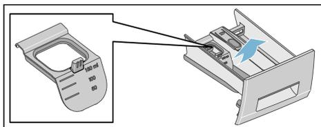
3. Limpiar el cajón para detergente y el accesorio con agua y un cepillo, después secarlo. Limpiar también el interior del bastidor.
