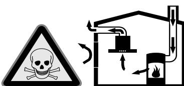
Kurišča, odvisna od zraka v prostoru (npr. grelne naprave na plin, olje, les ali premog, pretočni grelniki, bojlerji) črpajo zrak za izgorevanje iz prostora, v katerem so nameščeni, in odvajajo izpušne pline prek sistema za odvajanje plinov (npr. dimnika) na prost.
