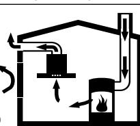
Vatrišta koja zavise od vazduha u prostoriji (npr. grejni uredaji na gas, ulje, drvo ili ugalj, protočni bojleri, kotlovi za zagrevanje vode) vazduh za sagorevanje crpe iz prostorije u koju su postavljeni i izdunve gasove izbacuju preko sistema za izdunve gasove (npr. kamoin) u spolašnju sredinu.
