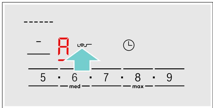
2. U sledećih 10 sekundi u opsegu za podešavanje izaberite željeni stepen temperature.
