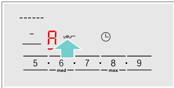
2. Tijekom sljedećih 10 sekundi u području namještanja odaberite željeni stupanj temperature.
