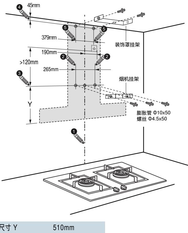
**提示:** 尺寸Y的下沿是油烟机的最低点（不包含油杯）。
