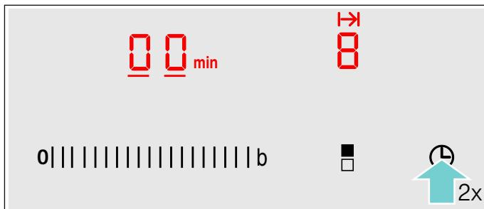
3. Pulsar el ajuste previo deseado en la zona de programación. El ajuste previo posible es de izquierda a derecha 1, 2, 3.... hasta 10 minutos. En los 10 segundos siguientes, deslizar el dedo por la zona de programación todas las veces que sea necesario hasta alcanzar la duración deseada.
