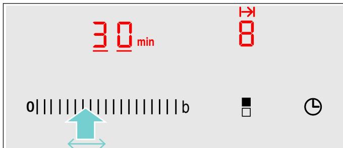
Se inicia el transcurso de la duración programada. Si se ha programado una duración del ciclo de cocción para varias zonas de cocción, en el indicador aparecerá siempre la duración de la zona de cocción seleccionada.
