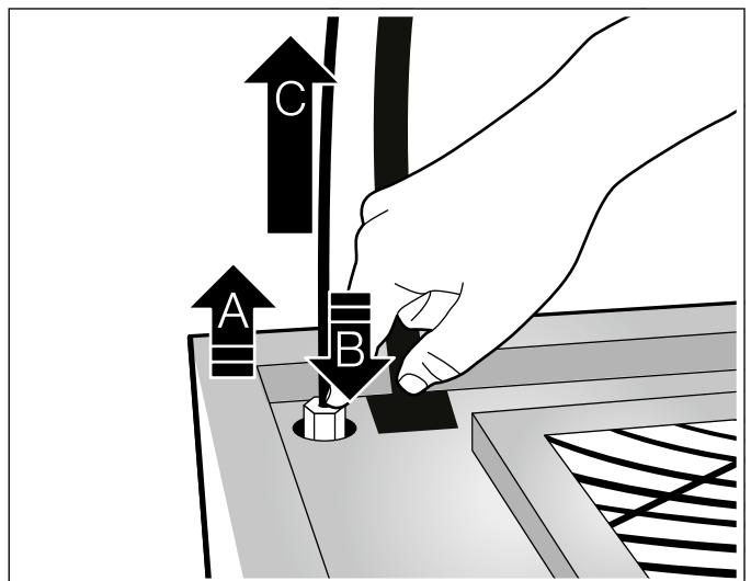
5. Nach dem Ausrichten die Seilspanner handfest festdrehen. Kein Werkzeug verwenden.
