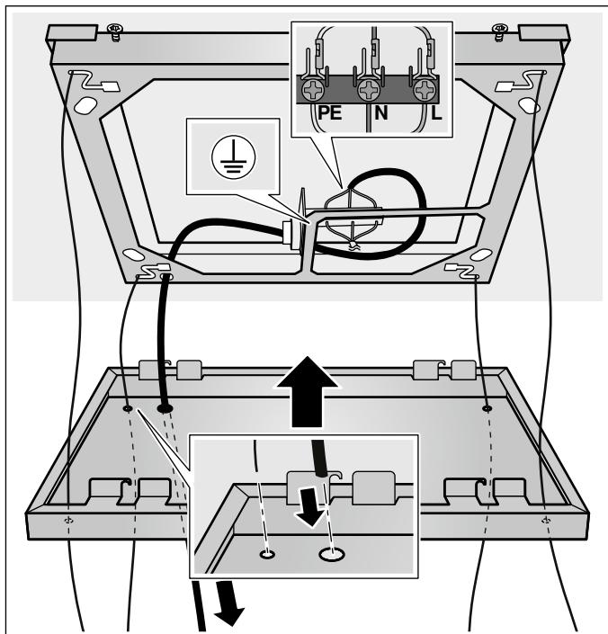
2. Rahmenabdeckung an den 4 Schrauben am Rahmenrand einhängen.
