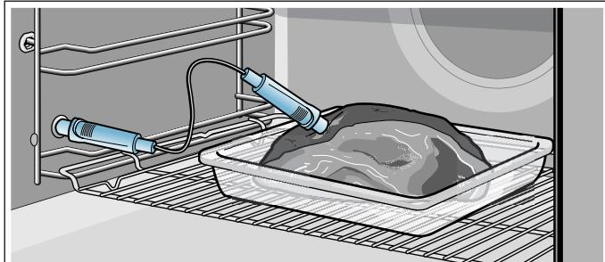
**Pollame:** infilare il termometro per arrosti nella parte più spessa del petto di pollo. A seconda delle caratteristiche del pollame inserire il termometro per arrosti trasversalmente o nel senso della lunghezza. Disporre il pollame intero sulla griglia con il lato del petto rivolto verso il basso.
