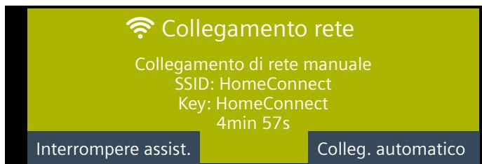
4. Registrare il terminale mobile alla rete del forno con la SSID "HomeConnect" con la key "HomeConnect".
