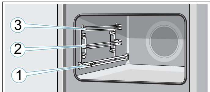
Ai livelli di inserimento 2 e 3, inserire l'accessorio sempre tra entrambe le aste di guida di un livello di inserimento.
