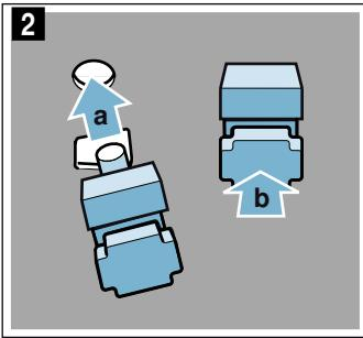
3. Agganciare il fermo posteriore con il gancio nel foro superiore **a** e inserirlo nel foro inferiore **b** (figura 3).
