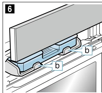
9. Spingere lentamente verso il basso il pannello, poi premerlo all'indietro, fino alla sua completa chiusura. Il serbatoio acqua è riempito. Ora è possibile avviare il funzionamento con il vapore.
