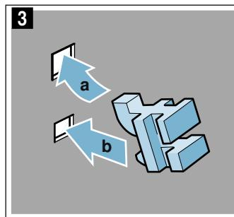
1. Applicare trasversalmente il supporto nella parte posteriore e inserirlo in alto e in basso **a** (figura 1).
