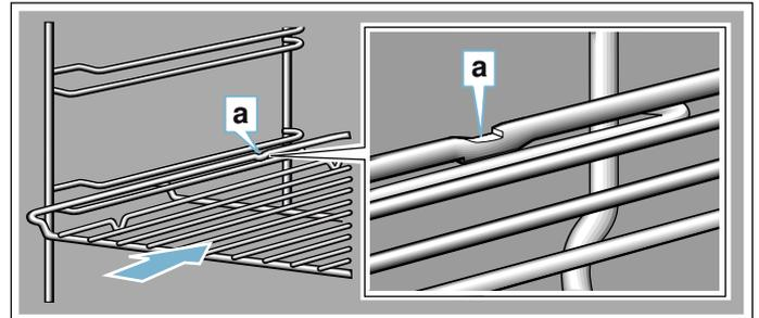
Al introducir las bandejas, asegurarse de que la muesca de enganche **a** se encuentra en la parte trasera y señala hacia abajo. El desnivel de los accesorios **b** debe señalar por delante hacia la puerta del aparato.
