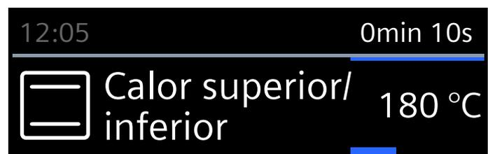
En la pantalla se muestran el tipo de calentamiento y la temperatura ajustados.
