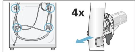
2. Aflojar y retirar los 4 tornillos de fijación para el transporte con una llave de tuercas SW13. Retirar los manguitos. Extraer para ello el cable de conexión de los soportes.
