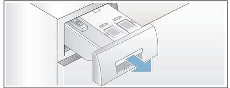
b) Tirar ligeramente hacia el cuerpo del usuario de la palanca de desbloqueo (A) situada en la parte posterior del tirador de la cubeta (zona inferior central) y, simultáneamente, tirar hacia arriba del tirador de la cubeta (B) desbloqueado.
