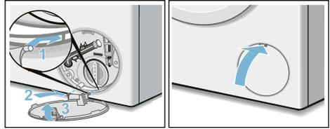
**Nota:** Con objeto de evitar que en el próximo lavado se evacue detergente sin haber sido usado; verter 1 litro de agua en la cámara
