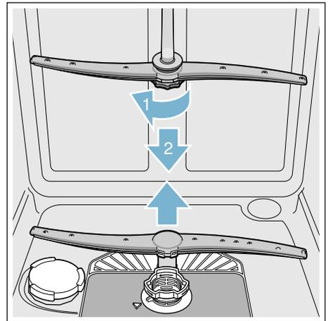
4. Sprüharme unter fließendem Wasser reinigen.
