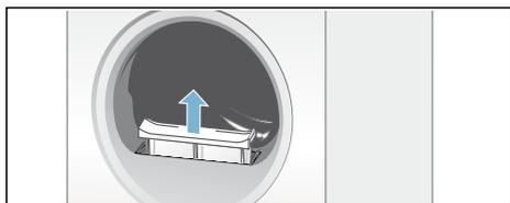
3. Retirez les peluches de la cavité du filtre à peluches.
