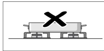
No utilice dos quemadores o fuentes de calor para un solo recipiente. Evite la utilización de planchas de asado, cazuelas de barro, etc. prolongadamente a máxima potencia.
