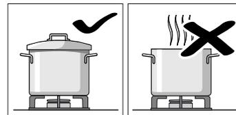
Χρησιμοποιήστε μόνο σκεύη με βάση επίπεδη και λεία. Μην μαγειρεύετε χωρίς καπάκι ή με μισό σκεπασμένο σκεύος. Χάνεται μέρος της ενέργειας.
