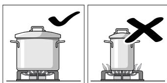
Χρησιμοποιήστε σκεύη κατάλληλου μεγέθους για κάθε καυστήρα.
