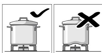
Coloque o recipiente bem centrado sobre o queimador. Caso contrário, o recipiente poderá virar-se. Não coloque os recipientes grandes sobre os queimadores próximos dos comandos. Estes podem ficar danificados devido ao excesso de temperatura.
