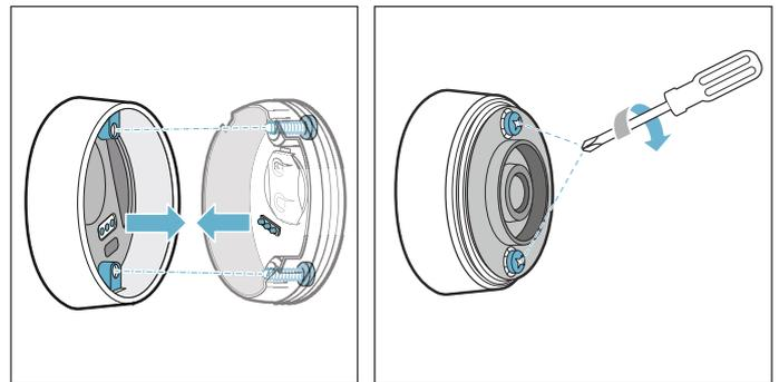
4. Στερεώστε το κάλυμμα σιλικόνης ξανά στο κάτω μέρος του περιβλήματος του αισθητήρα θερμοκρασίας.
