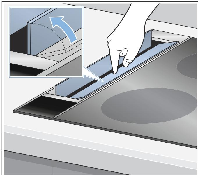
2. Ta tak i håndtaket på metallfettfilteret med to fingre og ta det ut.
