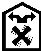
Liesituulettimen imemä ilma palautetaan rasvasuodattimien ja aktiivihiilisuodattimien puhdistamana takaisin keittiöön.
