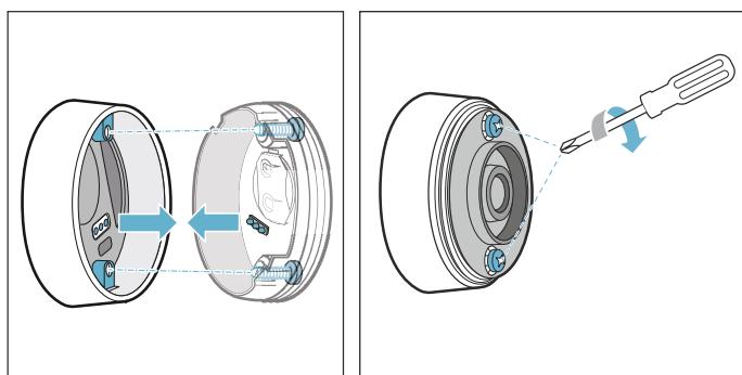
4. Asenna silikonisuojuksen takaisin paikalleen lämpötilatunnistimen kotelon alaosaan.
