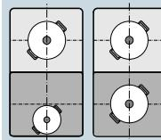
De främre och bakre kokzonerna har 2 induktorer var som går att använda oberoende av varandra. Ställ in det effektläge du vill ha på resp. kokzon. Använd bara en gryta på varje kokzon.
