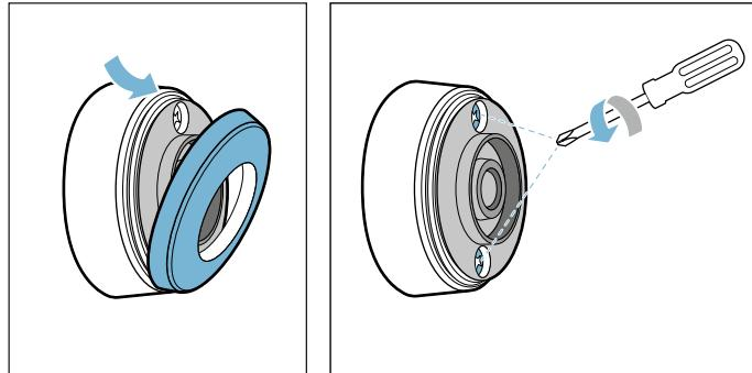
2. Irrota kotelon yläosa. Poista käytetty paristo. Työnnä uusi paristo paikalleen. Varmista, että navat ovat tällöin oikein.
