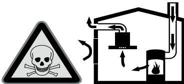
Vatrišta koja zavise od vazduha u prostoriji (npr. grejni uređaji na gas, ulje, drvo ili ugalj, protočni bojleri, kotlovi za zagrevanje vode) vazduh za sagorevanje crpe iz prostorije u koju su postavljeni i izdunve gasove izbacuju preko sistema za izdunve gasove (npr. kamoin) u spoljašnju sredinu.
