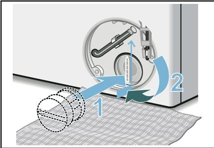
8. Service-Klappe einsetzen und einrasten.
