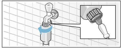
2. Schlauch wieder anschließen und auf Dichtheit prüfen.
