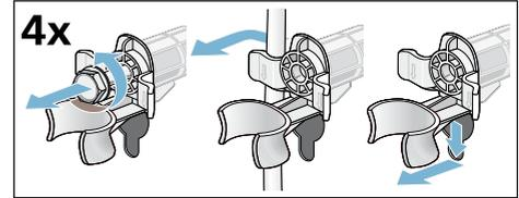
3. Abdeckungen einsetzen. Abdeckungen fest verriegeln durch Druck auf den Rasthaken.
