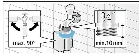
Wasserhahn vorsichtig öffnen und dabei Dichtheit der Anschluss-Stelle prüfen. Schraubverbindung steht unter Wasserleitungsdruck.
