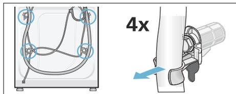
2. Alle 4 Transportsicherungsschrauben mit einem Schraubenschlüssel SW13 lösen und entfernen. Hülsen entfernen. Dabei Netzleitung aus den Halterungen nehmen.
