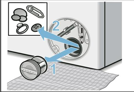
7. Pumpendeckel wieder einsetzen und verschrauben. Griff muss senkrecht stehen.
