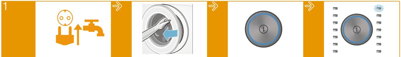
1 Netzstecker einstecken. Wasserhahn öffnen.
