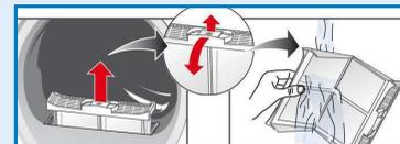
2. Beide Teile des Flusensiebes herausziehen.
