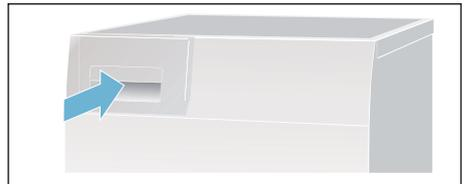
**Hinweis:** Das Sieb im Kondenswasser-Behälter filtert das Kondenswasser, das zur automatischen Reinigung Ihres Trockners verwendet wird. Das Sieb wird durch Entleeren des Kondenswassers gereinigt. Prüfen Sie das Sieb trotzdem regelmäßig auf verbliebene Ablagerungen und entfernen diese. Siehe → Seite 30.
