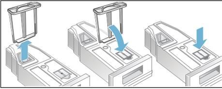
9. Schieben Sie den Kondenswasser-Behälter bis zum Einrasten ein.
