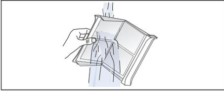
7. Trocknen Sie die Flusensiebe ab, klappen diese zu und setzen das zweiteilige Flusensieb wieder ein.
