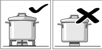
Așezați recipientele pe grătare, niciodată direct pe arzător.
