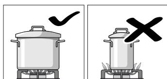
Χρησιμοποιήστε σκεύη κατάλληλου μεγέθους για κάθε καυστήρα.
