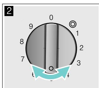
Para utilizar de nuevo la zona de cocción pequeña, gire el mando hacia la derecha hasta la posición 0 y conecte de nuevo.
