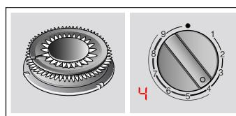
Flacără exterioară la putere minimă, flacără interioară la putere maximă.
