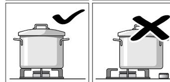
Nádobu umísťujte přesně na střed hořáku. V opačném případě by mohlo dojít k jejímu převržení. Nepokládejte velké nádoby na hořáky v blízkosti ovládacích knoflíků. Může dojít k poškození knoflíků v důsledku působení příliš vysokých teplot.
