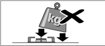
Previdno ravnajte s posodami na kuhalni plošči. Ne udarjajte po kuhalni plošči in nanjo ne postavljajte težkih predmetov.
