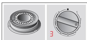
Вътрешен пламък на максимална мощност.
