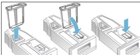
9. Poussez le réservoir d'eau de condensation jusqu'à ce qu'il se bloque.
