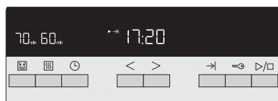
2. 触摸“预约”按键，控制器将自动计算出可设定的最早完成时间，并在显示屏上闪烁。
