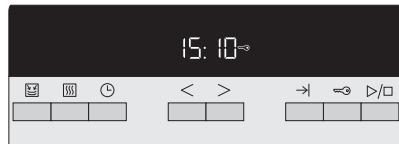
1. 触摸“童锁”按键3秒钟，童锁功能启动，显示屏将显示“~”符号；
