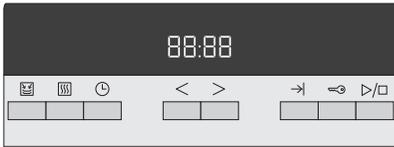
当您首次接通消毒柜的电源，或停电后再次接通时，显示屏显示闪烁的“88:88”。（如图所示）
