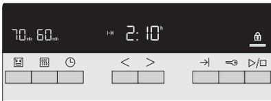
9. 控制器自动计算工作开始时间，到时间后自动进入工作程序，至设定好的时间工作结束。
