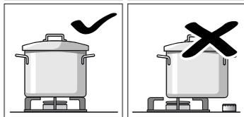
Coloque o recipiente bem centrado sobre o queimador. Caso contrário, o recipiente poderá virar-se. Não coloque os recipientes grandes sobre os queimadores próximos dos comandos. Estes podem ficar danificados devido ao excesso de temperatura.
