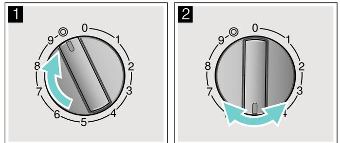
Para utilizar de nuevo la zona de cocción pequeña, gire el mando hacia la izquierda hasta la posición 0 y conecte de nuevo.
