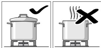
Não deve cozinhar sem tampa ou com a tampa mal colocada. Grande parte da energia é desperdiçada.
