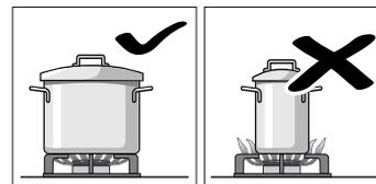
Χρησιμοποιήστε σκεύη κατάλληλου μεγέθους για κάθε καυστήρα.
