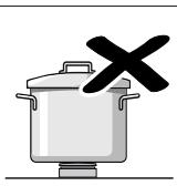
Coloque os recipientes sobre as grelhas e nunca directamente sobre o queimador. Antes de utilizar, certifique-se de que as grelhas e as tampas dos queimadores estão bem colocadas. Manuseie os recipientes com cuidado sobre a placa de cozedura. Não golpeie a placa de cozedura, nem coloque pesos excessivos sobre a mesma.
