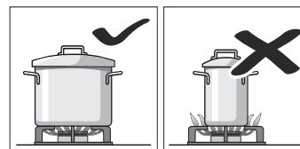
Χρησιμοποιήστε σκεύη κατάλληλου μεγέθους για κάθε καυστήρα.
