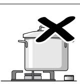
Τοποθετήστε το σκεύος καλά κεντραρισμένο πάνω στον καυστήρα. Σε αντίθετη περίπτωση μπορεί να γείρει. Μην τοποθετείτε μεγάλα σκεύη στους καυστήρες που βρίσκονται κοντά στους διακόπτες. Μπορεί να προκληθεί βλάβη λόγω υπερβολικής θερμοκρασίας.
