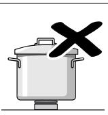
Coloque los recipientes sobre las parrillas, nunca directamente sobre el quemador. Asegúrese de que las parrillas y tapas de los quemadores estén bien colocadas antes de su uso. Maneje los recipientes con cuidado sobre la placa de cocción. No golpee la placa de cocción ni coloque sobre ella pesos excesivos.
