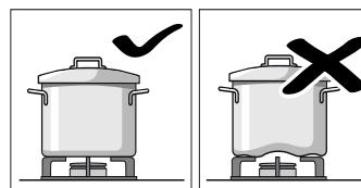
No utilice recipientes deformados que se muestren inestables sobre la placa de cocción. Los recipientes podrían volcar. Utilice solo recipientes de base plana y gruesa.
