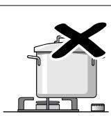
Coloque o recipiente bem centrado sobre o queimador. Caso contrário, o recipiente poderá virar-se. Não coloque os recipientes grandes sobre os queimadores próximos dos comandos. Estes podem ficar danificados devido ao excesso de temperatura.
