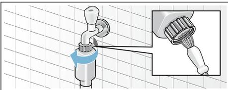
2. Schlauch wieder anschließen und auf Dichtheit prüfen.
