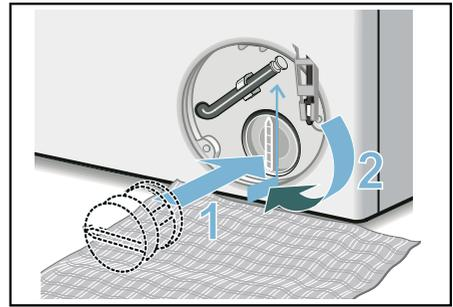
8. Service-Klappe einsetzen und einrasten.
