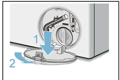
5. Entleerungsschlauch aus der Halterung nehmen. Verschlusskappe abziehen, Lauge in geeignetes Gefäß abfließen lassen.
