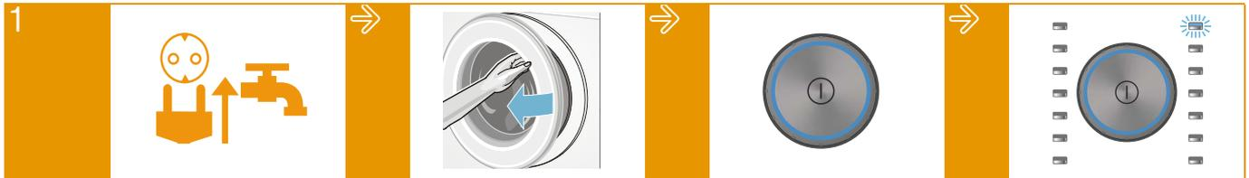
1 Netzstecker einstecken. Wasserhahn öffnen.
