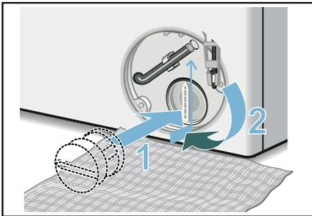
8. Service-Klappe einsetzen und einrasten.
