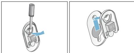
2. Introducir los cuatro manguitos. Fijar bien el cable de alimentación en los soportes. Introducir y apretar los tornillos.
