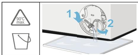
5. Desenroscar con cuidado la tapa de la bomba, ya que podría salir agua residual. Limpiar el interior, la rosca de la tapa de la bomba y la carcasa. La
