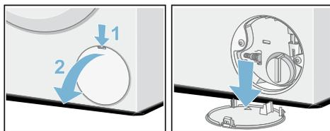
4. Extraer la manguera de desagüe del soporte. Retirar el tapón de cierre y recoger el agua de lavado en un recipiente adecuado. Volver a colocar el tapón de cierre y la manguera de desagüe en el soporte.
