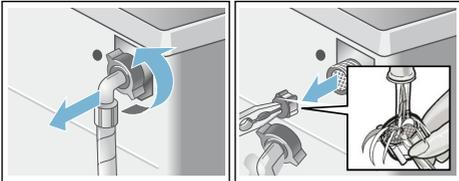
7. Insertar el filtro, conectar la manguera y comprobar que no hay fugas.
