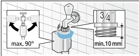
**Nota:** Abrir la llave de agua con cuidado y comprobar la estanqueidad de los empalmes. La unión roscada se encuentra sometida a presión de agua.
