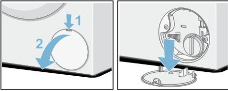
4. Rimuovere il tubo flessibile di scarico dal supporto. Rimuovere il tappo di chiusura e permettere all'acqua di fluire nell'apposito contenitore. Sostituire il tappo di chiusura e collocare il tubo flessibile di scarico nel supporto.
