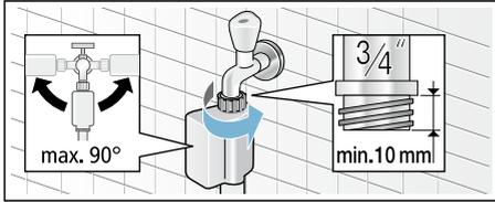
**Avvertenza:** Aprire con cautela il rubinetto dell'acqua, controllando la tenuta dei punti di collegamento. Il raccordo a vite è sotto la pressione delle tubature principali dell'acqua.
