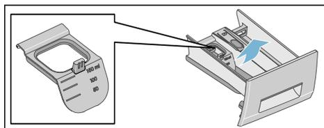
3. Lavare il cassetto del detersivo e l'inserto con acqua e una spazzola, e asciugarlo. Pulire anche l'interno della struttura.
