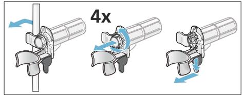
3. Montare le coperture. Bloccare saldamente in posizione le coperture facendo pressione sugli agganci a scatto.
