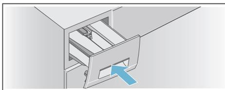
**Avvertenza:** Lasciare il cassetto del detersivo aperto in modo che ogni residuo di acqua si possa asciugare.
