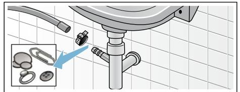
4. Ricollegare il tubo flessibile di scarico e assicurare il collegamento tramite la fascetta del tubo flessibile.
