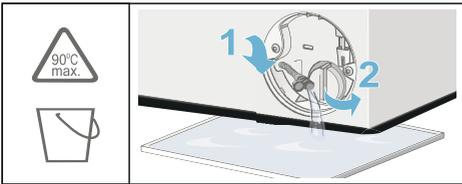
5. Svitare con cautela la copertura della pompa; è possibile la fuoriuscita di acqua residua. Pulire la parte interna, la filettatura della copertura della pompa e la struttura della pompa. La girante all'interno della pompa di scarico deve poter ruotare liberamente. Applicare nuovamente la copertura della pompa e avvitare saldamente. L'impugnatura deve essere in posizione verticale.
