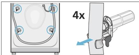
2. Rimuovere il cavo di alimentazione dai supporti. Svitare e rimuovere tutte le quattro viti dei fermi di trasporto. Rimuovere le boccole.
