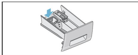
5. Inserire completamente il cassetto del detersivo.
