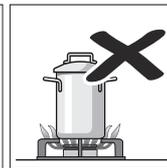
Χρησιμοποιήστε σκεύη κατάλληλου μεγέθους για κάθε καυστήρα. Να μη χρησιμοποιείτε μικρά σκεύη πάνω σε μεγάλους καυστήρες. Η φλόγα δεν πρέπει να αγγίζει τα πλευρικά τοιχώματα του σκεύους.
