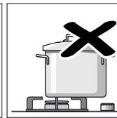
Τοποθετήστε το σκεύος καλά κεντραρισμένο πάνω στον καυστήρα. Σε αντίθετη περίπτωση μπορεί να γείρει. Μην τοποθετείτε μεγάλα σκεύη στους καυστήρες που βρίσκονται κοντά στους διακόπτες. Μπορεί να προκληθεί βλάβη λόγω υπερβολικής θερμοκρασίας.
