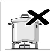
Μην χρησιμοποιείτε παραμορφωμένα σκεύη, τα οποία είναι ασταθή πάνω στην εστία. Τα σκεύη μπορεί να γείρουν. Χρησιμοποιήστε μόνο σκεύη με βάση επίπεδη και λεία.
