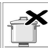
Τοποθετήστε τα σκεύη πάνω στις σχάρες, ποτέ απευθείας επάνω στον καυστήρα. Βεβαιωθείτε πριν από τη χρήση ότι οι σχάρες και τα καλύμματα των καυστήρων είναι καλά τοποθετημένα.
