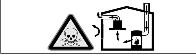
Hava dolaşımli ateşlikler (örneğin gaz, yağ, odun veya kömürle çalışan sobalar, şofbenler, su ısıtıcıları) yanma havasını kurulum yerinden alırlar ve atık gazı bir atık gaz sistemi (örneğin baca) kanalıyla dışarıya aktarırlar.
