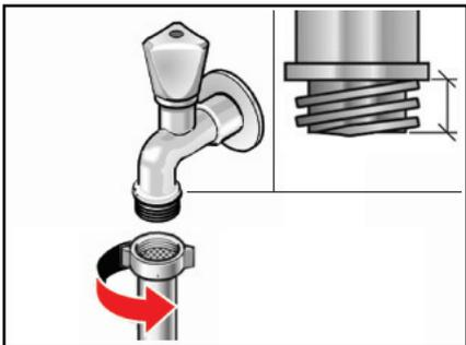
Nettoyage du filtre du robinet d'arrivée d'eau
