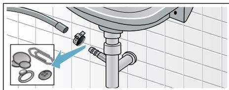
4. Ricollegare il tubo flessibile di scarico e assicurare il punto di collegamento tramite la fascetta del tubo flessibile.
