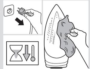
10 افصل المكواة عن الكهرباء و اترك قاعدة المكواة لتبرد. امسح قاعدة المكواة باستخدام قطعة قماش رطبة فقط.
