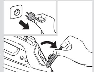
1 انزع قابس المكواة من المقبس الكهربائي.
