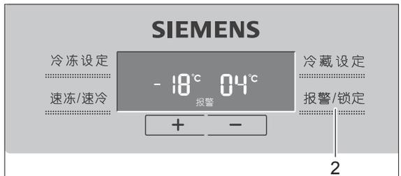
触摸“报警/锁定”键，关闭蜂鸣器，显示屏温度停止闪烁，并显示曾达到的报警温度约十秒钟，然后恢复显示原设定值，当箱内温度低于报警温度，“报警”字符将自动消失。
