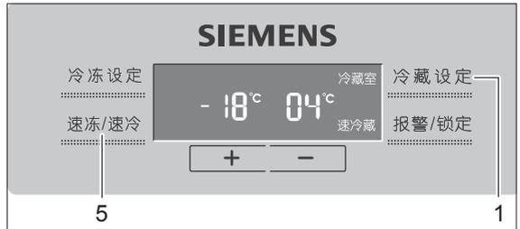
若想进入速冷藏运行模式，触摸冷藏设定键1，“冷藏室”字符点亮，接着触摸“速冻/速冷”键5，当“速冷藏”字符点亮，同时冷藏设定温度显示为2°C时，表示速冷藏模式已开始运行，冷藏室将在2°C设置下运行6小时左右，然后自动恢复到原设定状态。
