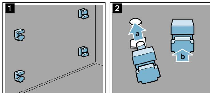
3. A l'arrière, accrocher le crochet de la fixation dans le trou supérieur **a** et la pousser dans le trou inférieur **b** (fig. **3**).
