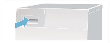
**Avvertenza:** Il filtro nel contenitore dell'acqua di condensa filtra l'acqua di condensa che viene utilizzata per la pulizia automatica dell'asciugatrice. Svuotando l'acqua di condensa il filtro viene pulito. Ciononostante controllare regolarmente che non ci siano depositi di impurità nel filtro. In caso contrario, rimuoverli. Vedere → *Pagina 30.*
