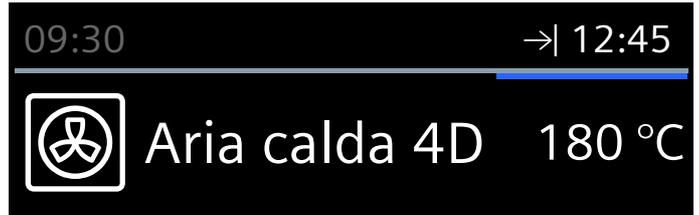
Il forno è in modalità standby. Nella barra di stato compare il simbolo
