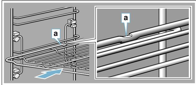
При установке противней следите за тем, чтобы фиксирующий выступ **a** находился сзади и был обращён вниз. Скошёный край противня **b** должен быть обращён вперёд к дверце прибора.
