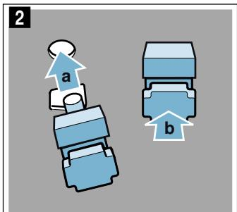
3. Установите крючок заднего держателя в верхнее отверстие **a** и вставьте держатель в нижнее отверстие **b** (рис. 3).
